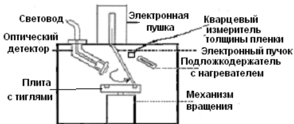
Рис. 4.16. Установка для получения тонких сверхпроводящих пленок из YBCO
