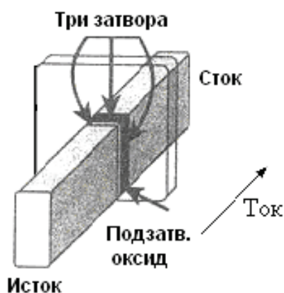
Рис. 1.13. Схема поплавкового транзистора с тремя затворами
