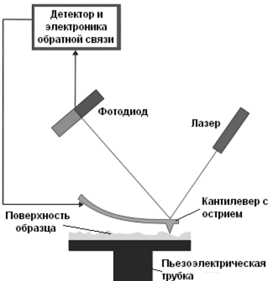
Рис. 3.32. Принципиальная схема атомно-силового микроскопа
