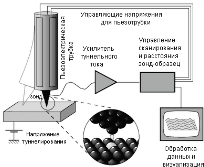
Рис. 3.31. Принципиальная схема сканирующего туннельного микроскопа
