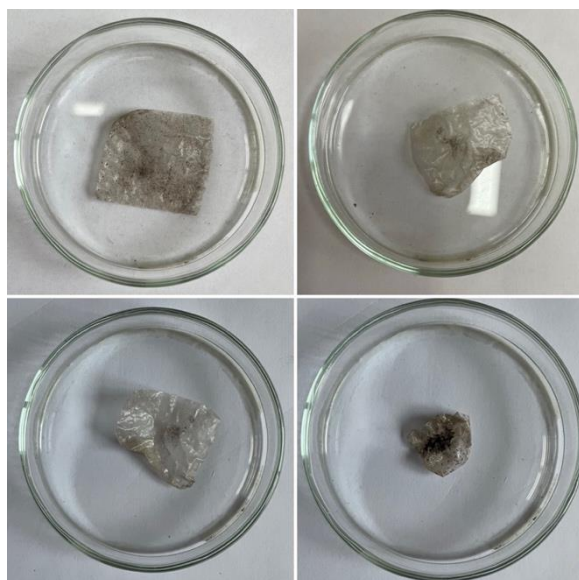
Рисунок 3.34 – Оцінка біорозкладності композитів NC-PVA на основі зображень (а), графік залежності маси сенсорів від часу перебування в ґрунті (б)
