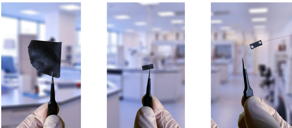
Рисунок 4.1 – Маршрут синтезу композитів NC-PVA-C (а) та виготовлення датчиків згину на їх основі (б)
