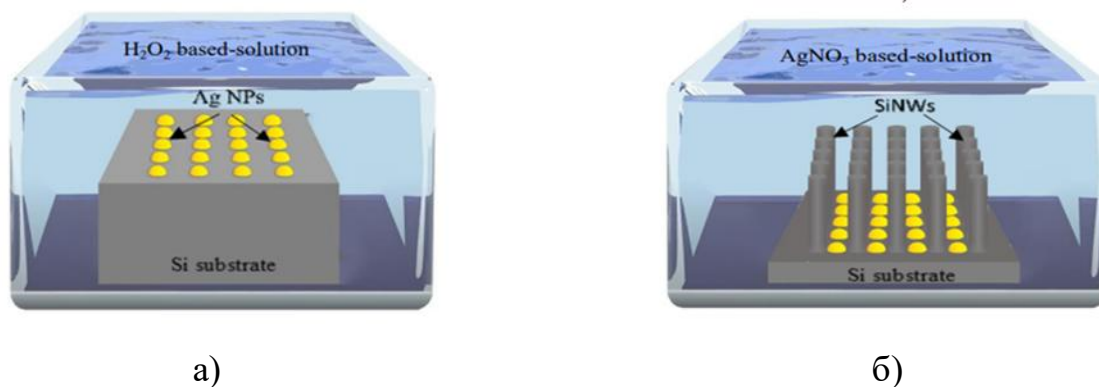
Рисунок 1.4 – Схематична ілюстрація процесу створення КНН методом МСХТ: перша стадія (а), друга стадія (б) [20]
