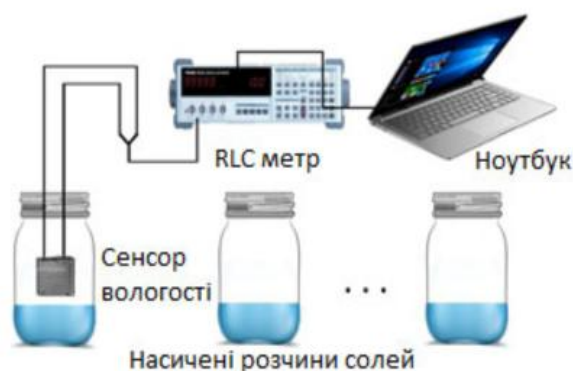
Рисунок 2.7 – Структура вимірювального стенду для дослідження сенсорів вологості
