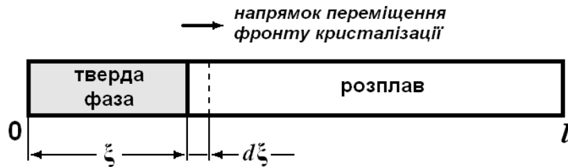
Рис. 5.1. Схема затвердіння при нормальній кристалізації
