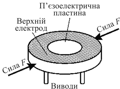
Рис. 3.35. П'єзоелектричний дисковий резонатор, застосовуваний в діаметральному датчику сили
