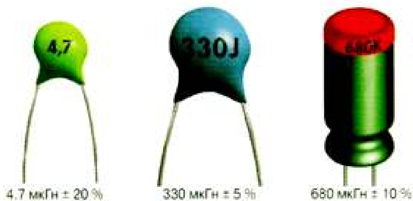
Рис.Д3.4. Маркування індуктивності за варіантом "Б" (безпосереднє).
